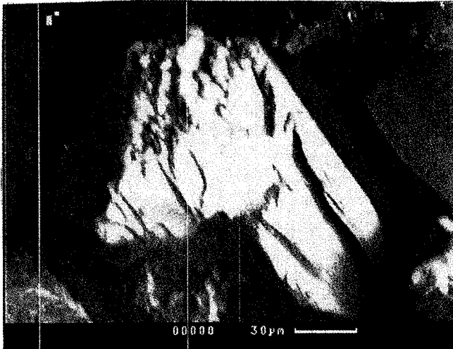
شكل (رقم ٤): المجس الدقيق يوضح عملية ذوبان أهورتلند.
