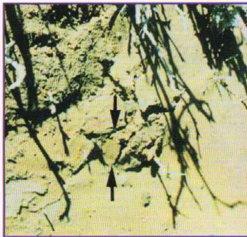
تشقق الأرض في اتجاهين عموديين - الأسهم تبين التشقق
